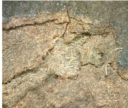
Abbildung 4 Verdeutlichung des Schichtaufbaus und der Faserstruktur des Vulkanfibers anhand einer Fehlstelle verursacht durch Flüssigkeit
