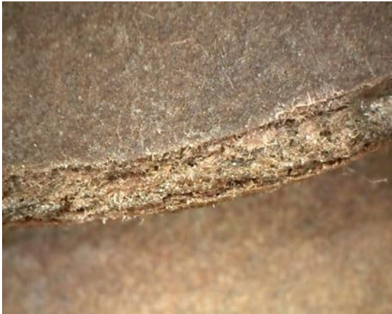
Abbildung 3 Griffloch Stirnseite: Verdeutlichung der Faserstruktur anhand der Schnittkante
