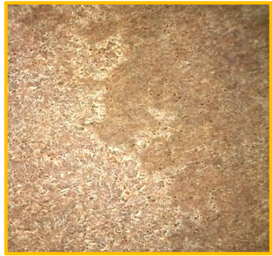
Abbildung 5 Unter USB - Mikroskop hellen Bereich mit Schichttrennung, dunkler Bereich ist verdichtet und glatt
