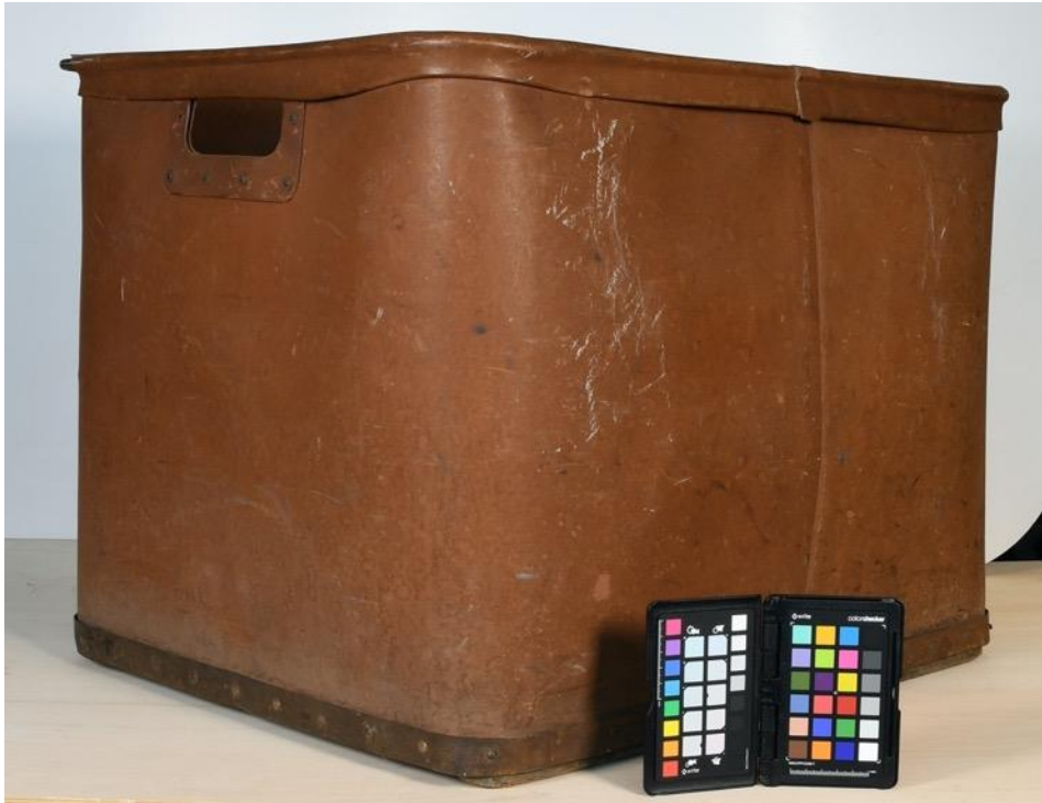
Abbildung 1 Transportkasten aus DYNOS Vulkanfiber, Inventarnummer 2.022
