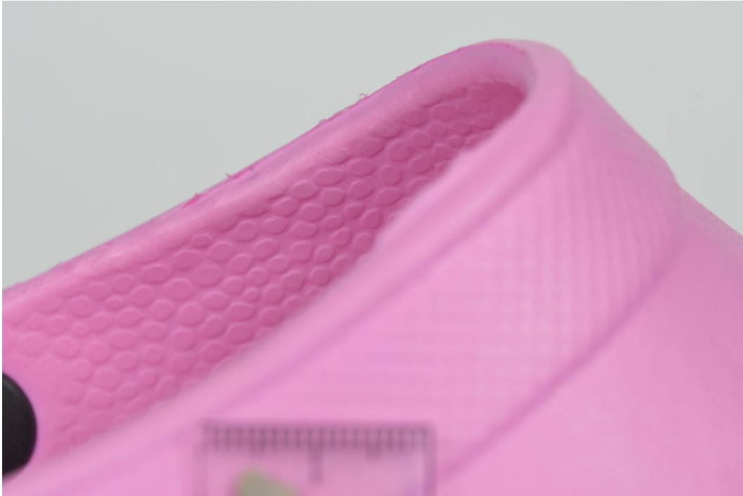
Abbildung 4: Oberflächenstruktur der Fläche im Schuhinneren (F3)
