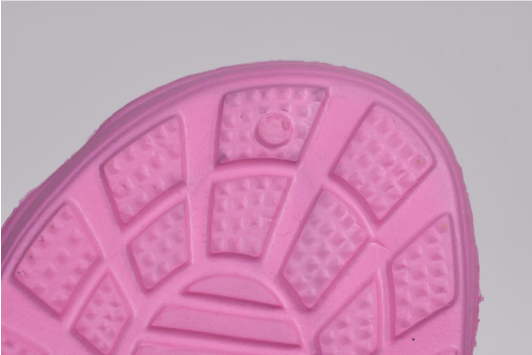
Abbildung 12: Ausstoßpunkt an der Spitze der Schuhsohle
