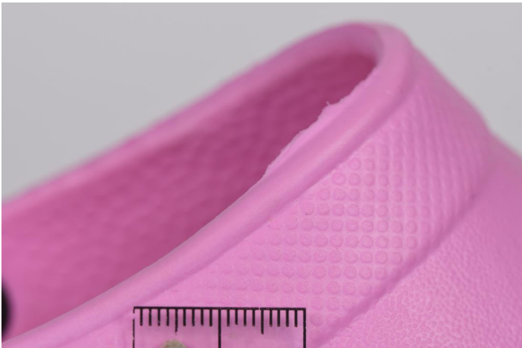
Abbildung 2: Oberflächenstruktur von Fläche (F1) und Kantenband (F2), Schuh außen
