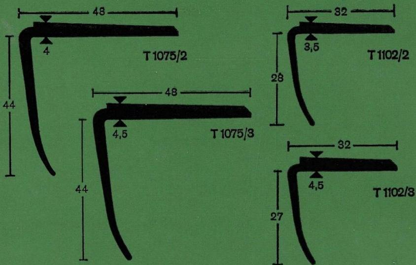
**Mipolam®** Einputzsockelleisten (hart), Fertigungslänge 5 m
