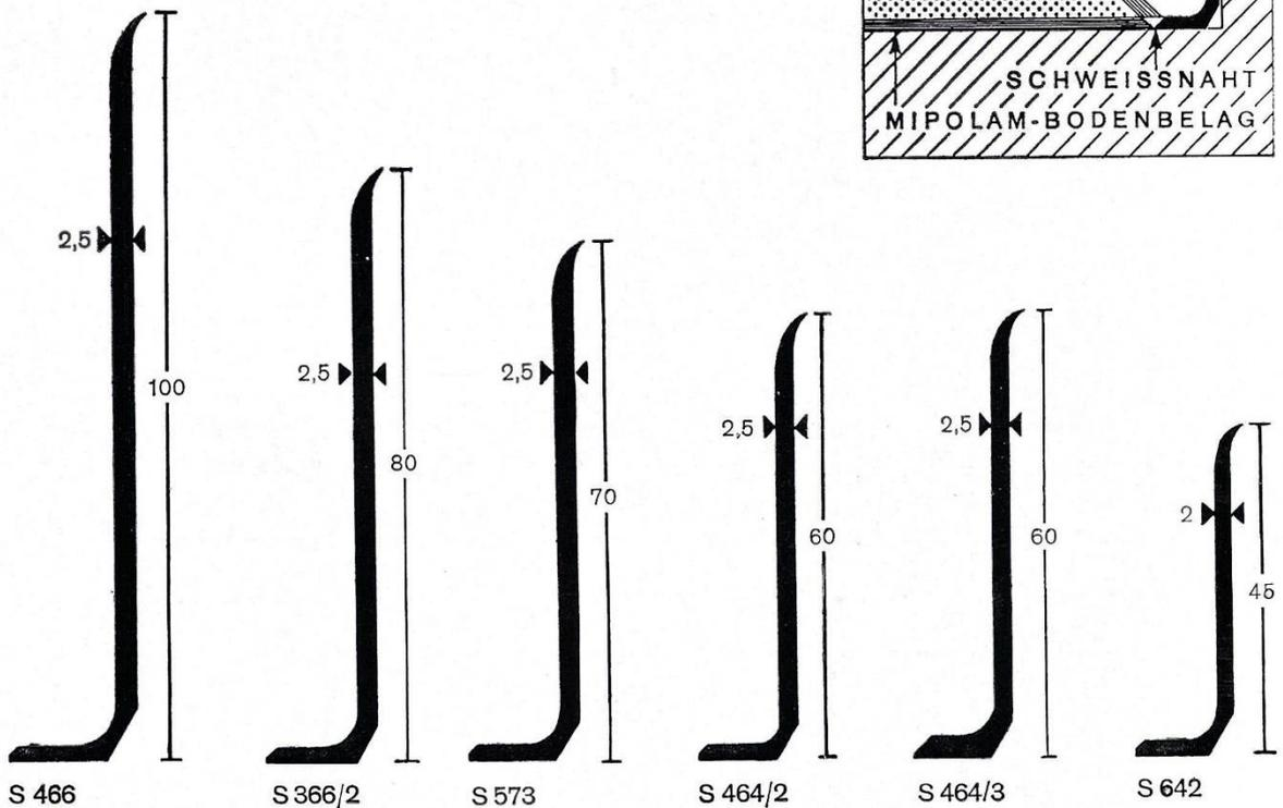
**Mipolam<sup>®</sup>** Treppenkantenprofile, Fertigungslänge 4,50 m
