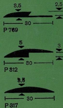
**Mipolam®** Spezialprofile für textile Bodenbeläge, Fertigungslänge 4,50 m
