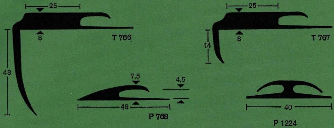
**Mipolam®** Spezialprofile für 3 mm Filzbelag, Fertigungslänge 4,50 m und 25 m\*
