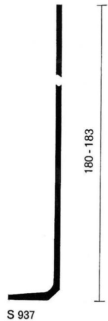
**Mipolam®** Treppenkanten (Schweißprogramm) Fertigungslänge 4,50 m
