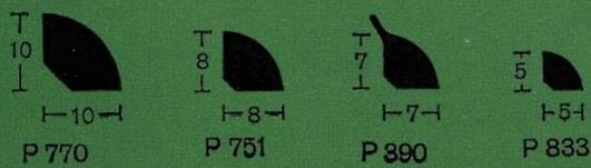
**Mipolam®** Wangenprofile, Fertigungslänge 5 m
