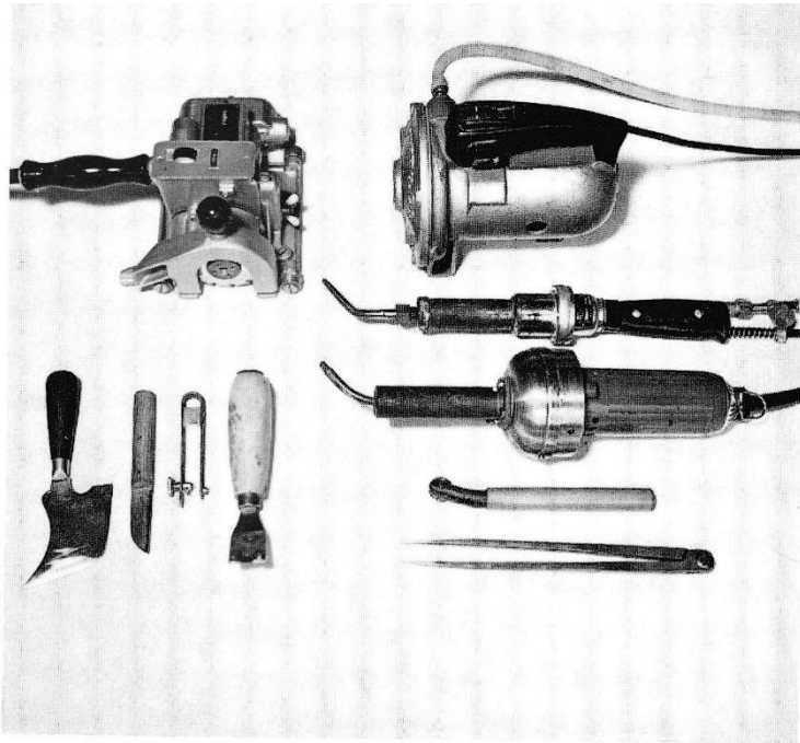
Abb. 32 Verlege- und Schweißgeräte.
