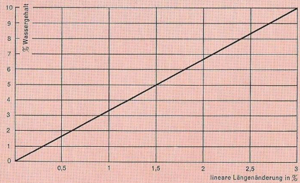
Kurve 3 Lineare Längenänderung von TROGAMID B in % bei Wasseraufnahme
