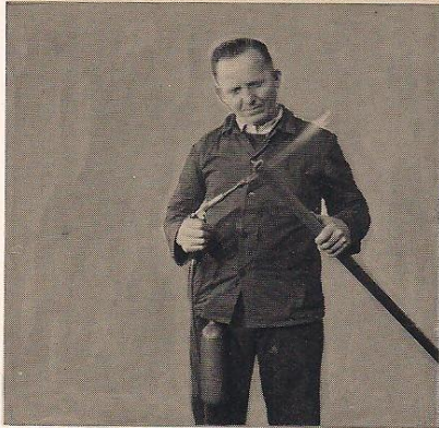
Erwärmung des Dynadur-Rohres mit dem Propanbrenner. Die Gasflasche wird am Gürtel getragen.
