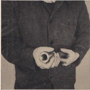
Das erwärmte und erweichte Ende des Dynadur-Rohres wird in die Kalibrierbuchse eingeschoben
