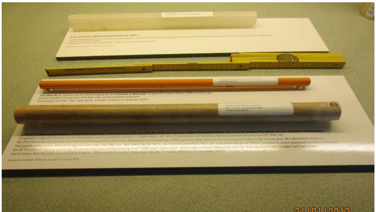
Von oben: Ein PVDF-Rohr (Dyflor) aus der Fertigung von Dynamit Nobel AG; ab 1973 gefertigt. Diese Rohre waren durch eine hohe Chemikalienbeständigkeit ausgezeichnet, selbst bei Temperaturen bis 120 °C. Auf unserer homepage [www.kunststoff-museum.de](http://www.kunststoff-museum.de) wird dies unter → „Die Bibliothek“ – „PVDF im Chemieanlagenbau“ beschrieben.
