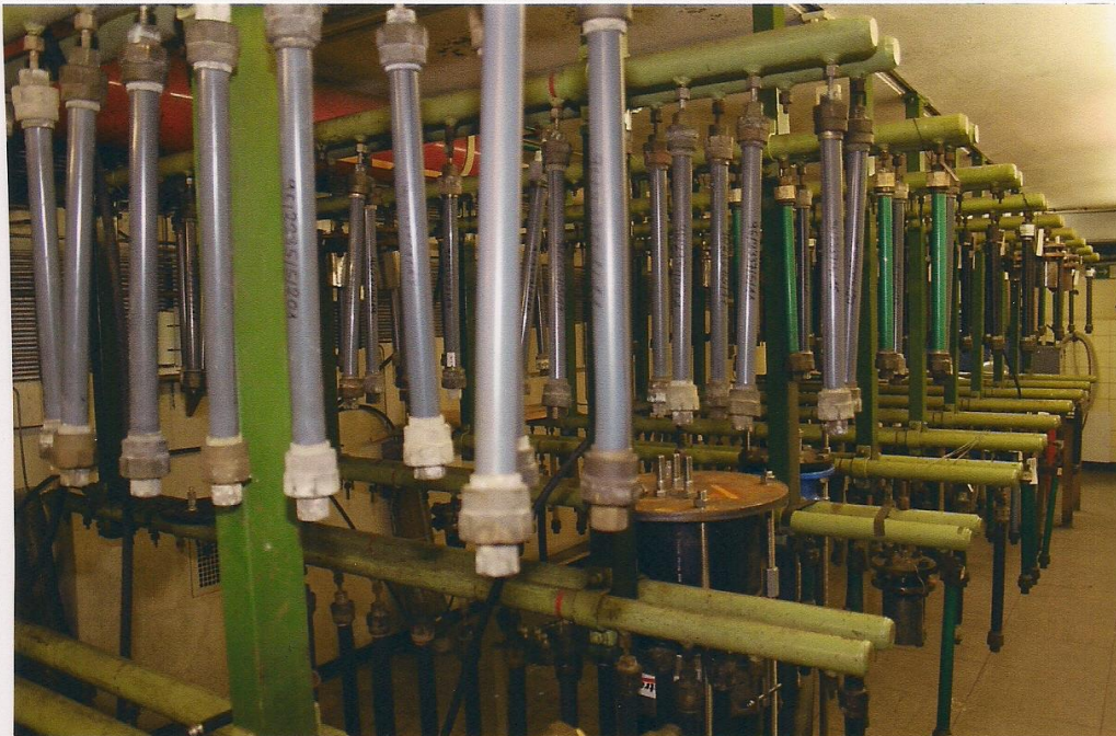
Bild 3: Blick auf die bis zu 800 Prüfrohre zur Prüfung in klimatisierter Luft bei 20 °C
