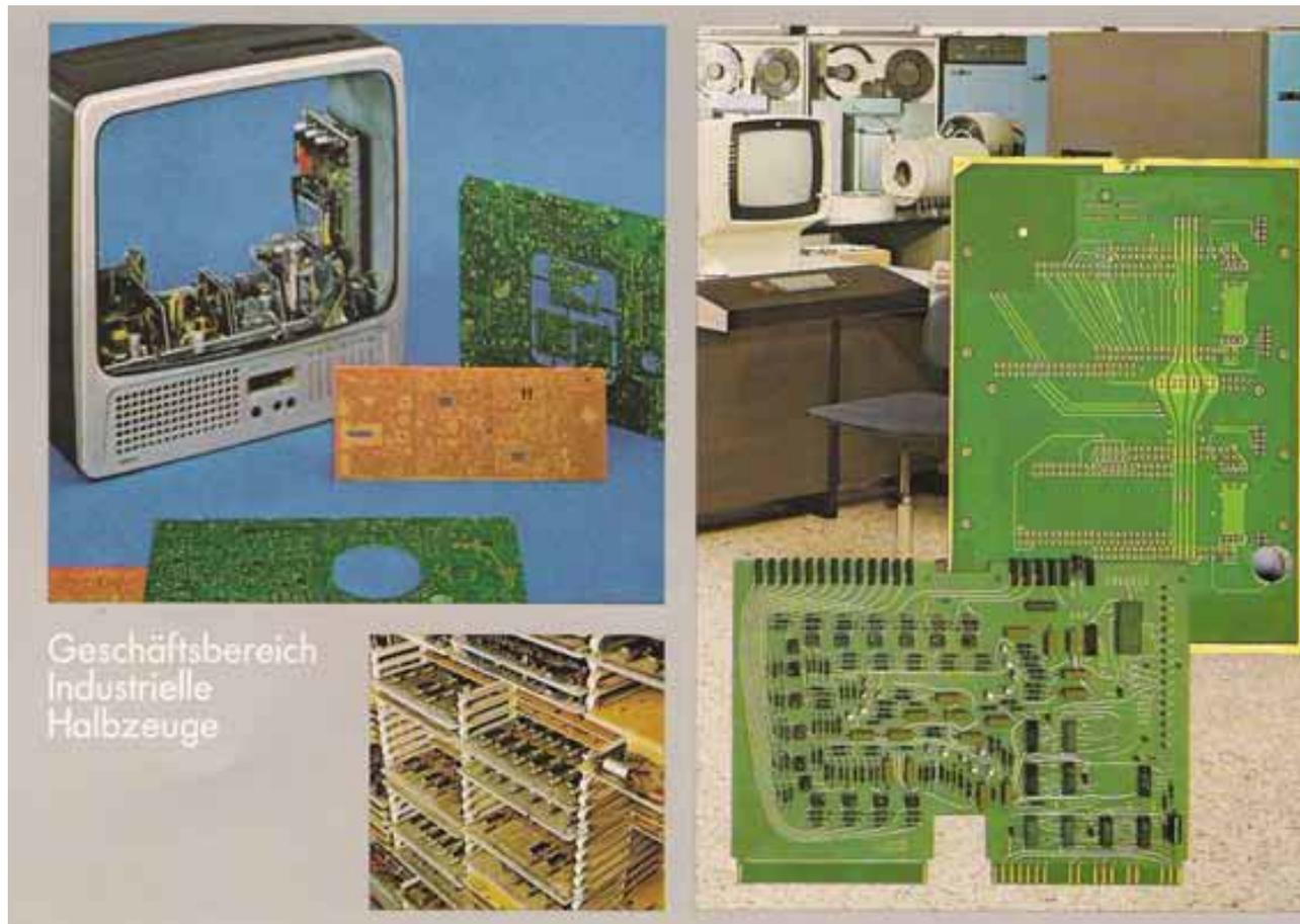
Trolitax-Pressplatten bestanden aus verpressten ausgehärteten phenolharzgetränkten Papierlagen und Kupferfolie (Hartpapier) oder aus verpressten ausgehärteten epoxidharzgetränkten Glasgewebelagen mit Kupferfolien (EPG)
