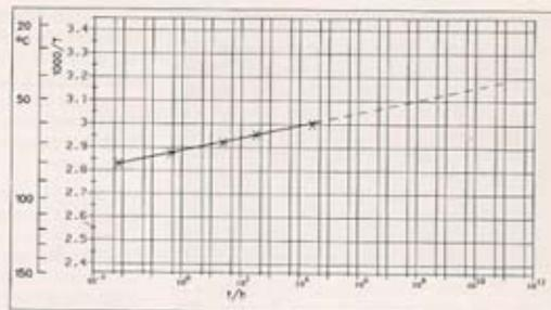
Bild 19: Arrhenius-Diagramm aus Zeitstand-Innendruckversuchen an PVC-Rohren mit 10 N/mm<sup>2</sup> bei 80 - 65 °C.
