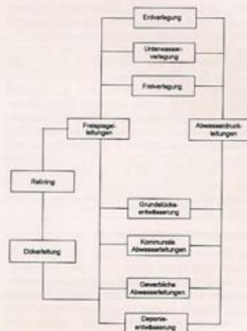
Bild 20: Einsatzbereiche von PVC-U-Rohren
