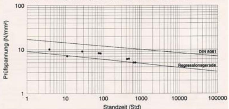
**Bild 18:** Zeitstand-Innendruck-Diagramm aus Innendruck-Versuchen an den Vinidur-Rohren 24 und 25 bei 60 °C.
