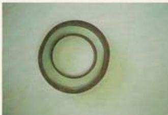
**Bild 15: Querschnitt von 2 Vinidur-Rohringen aus Bitterfeld mit deutlicher Unrundheit und Wanddickenschwankungen.**
