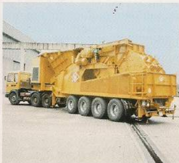
Herstellung und Wiederverwendung von Baustoffen: Mobile Brechanlage zur Aufbereitung von Ausbaustoffen. ▼
