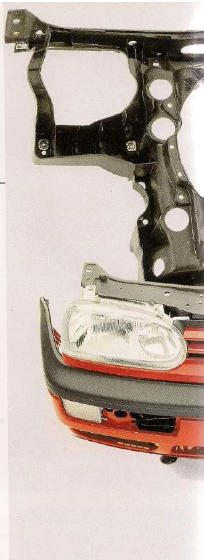
Kunststoff-Montageträger für den Frontbereich des VW-Golf, gefertigt auf 2.000-t-Pressen. ▶
