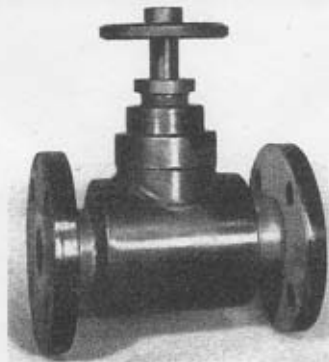
Bild 6. Geradsitzventil. Der Ventilkörper besteht aus einzelnen aufgeschraubten „Vinidur“-Rohren. Der Ventil Aufbau besteht aus spanabhebend hergestellten Vinidur-Teilen und ist durch Gewinde, Schweißung bzw. Klebung mit dem Ventilkörper verbunden
