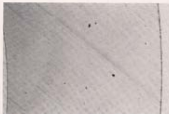
Bild 10: Querschnitt durch die Rohrwand der Probe-Nr.: 14 (32 x 4,0 mm) Durchlicht aus Mikrotomschnitt, Vergr. 30 : 1.
