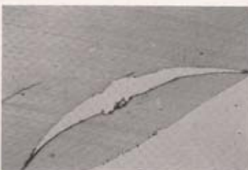
Bild 12: Größerer Riß in der Rohrwand der Probe Nr. 7. Durchlicht aus Mikrotomschnitt, Vergr. 40 : 1.
