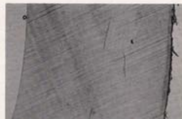
Bild 11: Querschnitt durch die Rohrwand der Probe Nr. 15 mit Rissen parallel zu den Oberflächen und geschädigter Außenoberfläche. Durchlicht aus Mikrotomschnitt, Vergr. 25 : 1.
