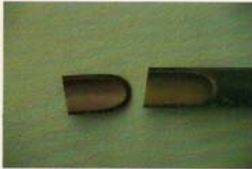
Bild 9: Innenoberfläche des Vinidur-Rohres Nr. 24 nach über 50jährigem Einsatz ohne Inkrustationen und Ablagerungen.
