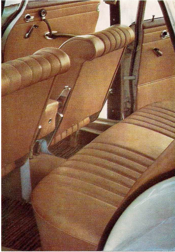
Automobilpolsterung, HF-geschweißt mit Trovipor
