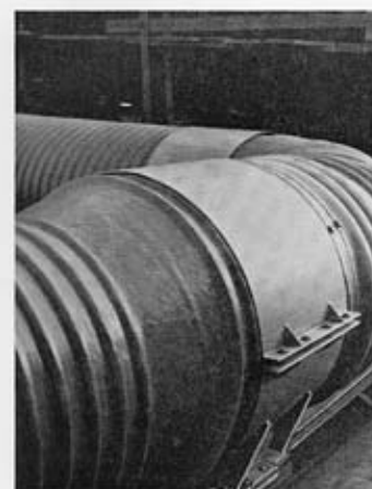
Abb. 26 Übergangsstück NW 1400/1250 aus Trovidur PVC hart Platten, geschweißt und mit GFP verstärkt
