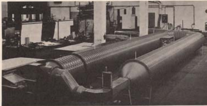
Bild 5 Versuchseinrichtung zur Bestimmung der Auflagerabstände von Trovidur Spiralrohren.
