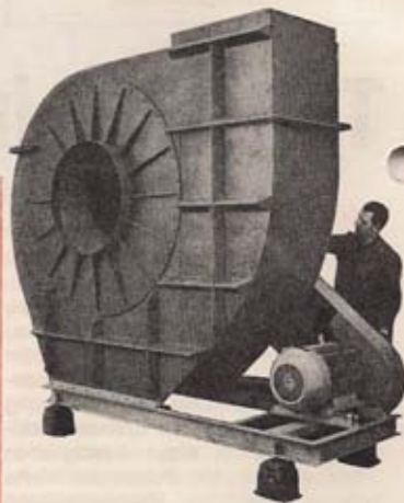
Bild 4 Mitteldruckventilator mit Grundrahmen, Antrieb und Schwingungsdämpfern
