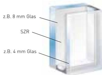
Verwendung eines asymmetrischen Scheibenaufbaus im Mehrscheiben-Isolierglas für ein verbessertes Schwingungsverhalten (stärkere Entkopplung des Systems)
