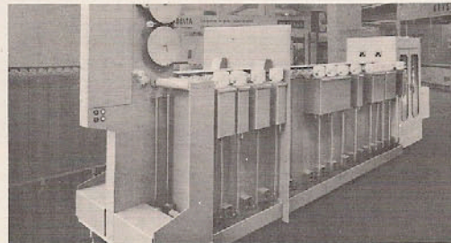
Bild 3 Hostert Automata — Continuous-Filmentwicklungsmaschine aus Trovidur (Walter Hostert pers.)
