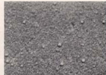
Bild 4 zeigt die REM-Aufnahme eines schwarzen Trocal-Color-Profiles nach 4jähriger Freibewitterung in Arizona (Vergrößerung 10000:1).
