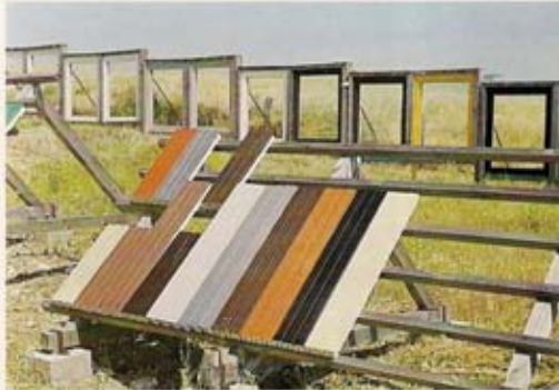
Bild 2. Freibewitterung von koextrudierten PVC-PMMA-Profilen und -Fenstern in Spanien.
