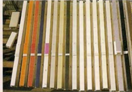
Bild 5. Koextrudierte PVC-PMMA-Profile nach fünfjähriger Freibewitterung unter 45° Süd in Troisdorf. Zur Beurteilung der Farbänderungen sind die unbelichteten Vergleichsmuster in der Mitte der bewitterten Profile aufgelegt.
