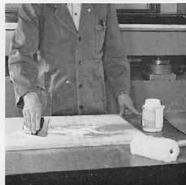
Auftrag von Folien-Emulsionsleim mit Kammspachtel und Lammfellrolle
