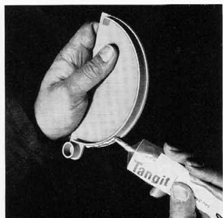
Auftragen des Klebers am Endstück
