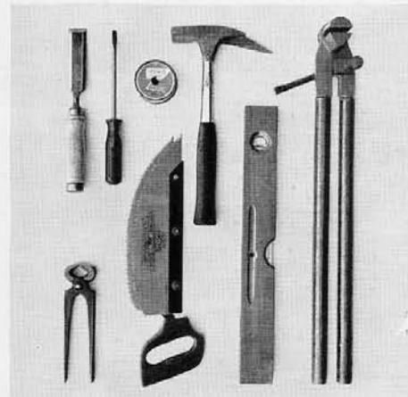
Werkzeuge für die Befestigung der Rinneneisen
