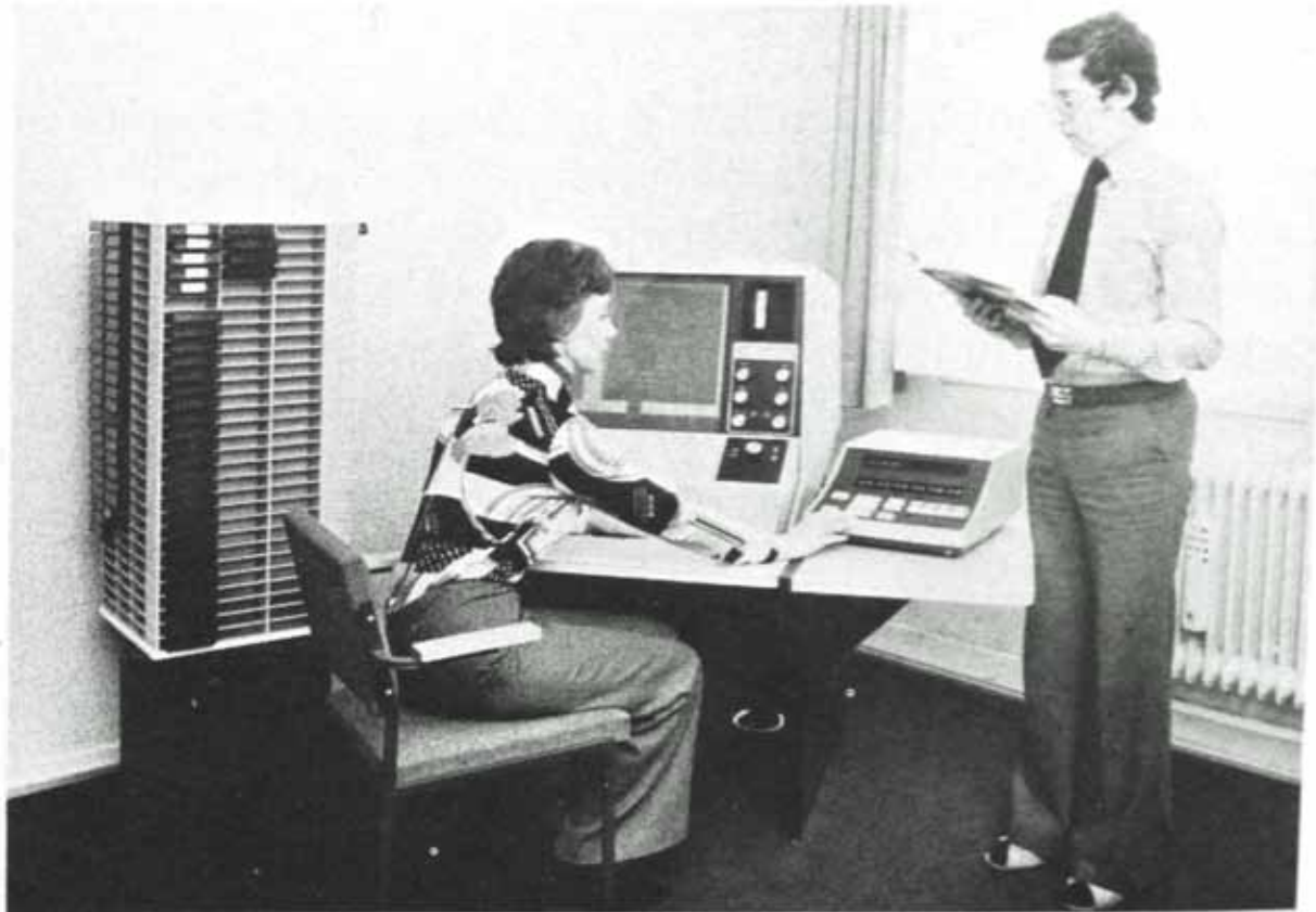
Bild 8. Miracode-Lese- und –Rückvergrößerungseinheit. Stapelturm für Filmkassetten (links), Steuergerät zur Dokument-Suche auf den Filmkassetten (Controller) (rechts)
