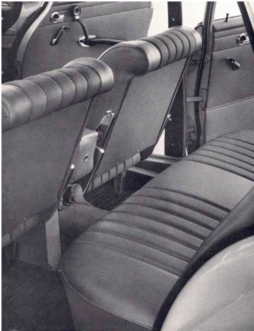
Trovipor, weichelastischer Schaumstoff aus PVC als Polstermaterial
