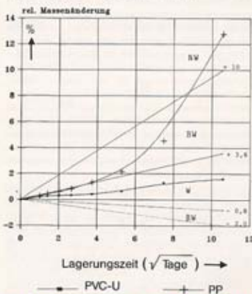
Bild 1: Massenänderung von PVC-U und PP während der Lagerung in Mischsäure (48 % H 2 SO 4 , 96 % ig + 50 % HNO 3 , 50 % ig + 2 % H 2 O) bei 40 °C
