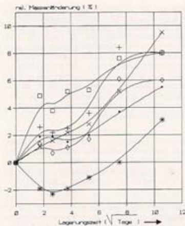
Bild 6: Massenänderung von PE-HD bei der Immersion in wäßrigen Lösungen von Kohlenwasserstoffen bei 23 °C
