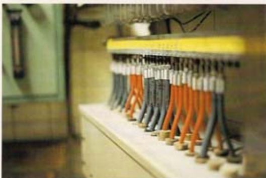
Bild 2: PVC-U-Rohre im Zeitstand-Innendruckversuch mit gleichzeitiger Chemikalieneinwirkung bei 60 °C
