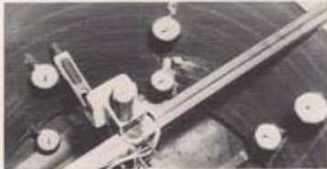
Abb. 17 Stahlbetonrohr DN 1250 mit einbetoniertem Spiralrohr beim Außendruckversuch. Sichtbar sind die Manometer zur Erfassung des Außendruckes und der Meßfühler zur Bestimmung des Rohrdurchmessers.
