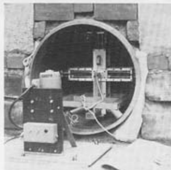
Abb. 9 Meßgerät zur Erfassung des vertikalen und horizontalen Rohrdurchmessers beim Einsatz in einem Rohr DN 630.
