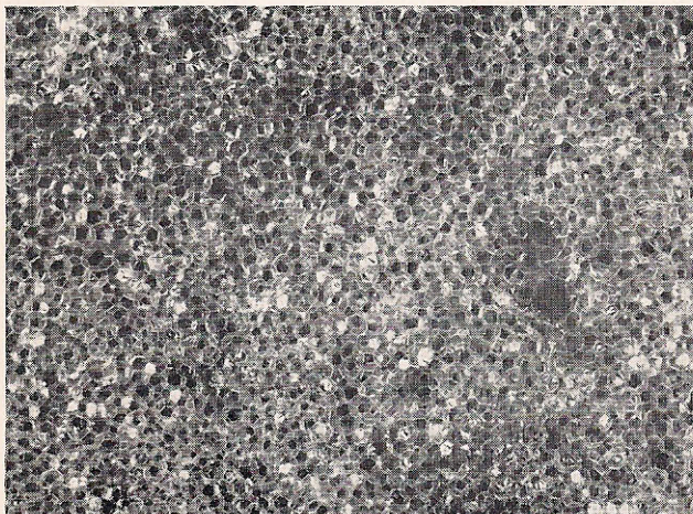
Bild 1 Porenstruktur von Phenolharz-Schaumstoff. Dieses Bild zeigt in etwa zehnfacher Vergrößerung die wabenartige Vernetzung der Schaumstoffzellen. (Werkfoto: Dynamit Nobel AG)
