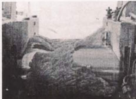
Es dauerte geraume Zeit bis man erkannte, daß sich PVC-Pulver auf erwärmten Zylindern plastifizieren läßt ...
