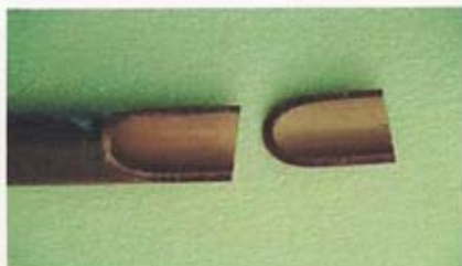
Probeschnitt durch ein Vinidur-Rohr, das 50 Jahre lang in Bitterfeld im Einsatz war und weder Inkrustationen noch Ablagerungen zeigt [14]
