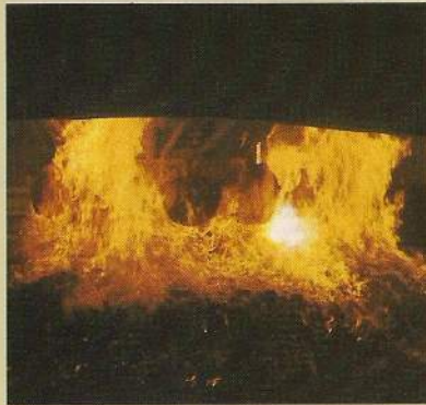
Silizium-Metall wird durch Reduktion von Quarz mit Kohle in offenen Elektro-Niederschichtöfen gewonnen.
