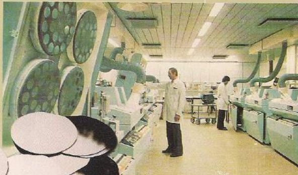
Die aus Einkristallstäben geschnittenen Siliziumscheiben werden getäpft, poliert und einzeln kontrolliert.
