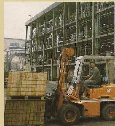
Anlieferung von Ferrosilizium an die Chlorsilan-Anlage, in der Siliziumtetrachlorid erzeugt wird
