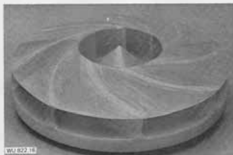
Abb. 16. Ventilatorlaufrad aus PVDF (Außendurchmesser 285 mm, Umfangsgeschwindigkeit 84,3 m/sec, für Belastung mit Säure- und organischen Lösemitteldämpfen bei 50 °C)
