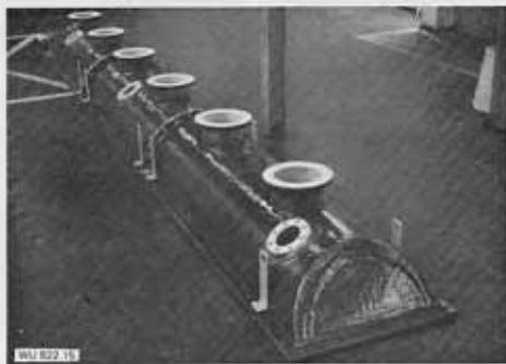
Abb. 15. Dreiteilige Haube aus PVDF, verstärkt mit GF-UP
