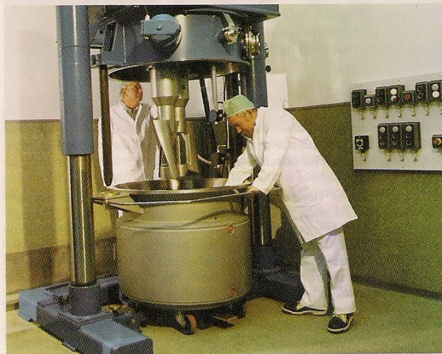
▲ Moderne Mischverfahren sichern genaueste Dosierung und gleichbleibend hohe Qualität der Nitro-Wirkstoffe.
