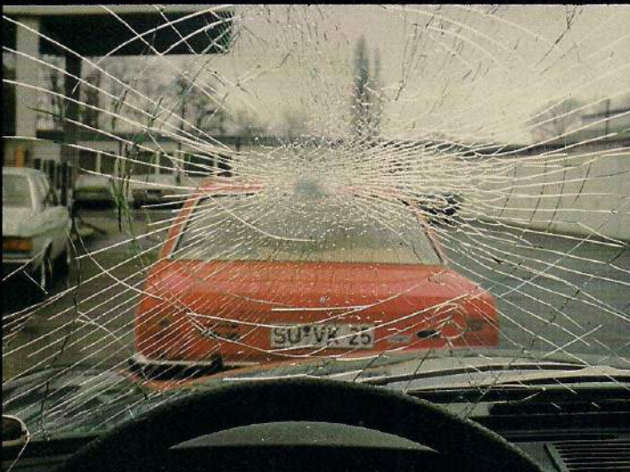
Mit Trosifol®-Folie armiertes Verbund-Sicherheitsglas nach Aufprall
