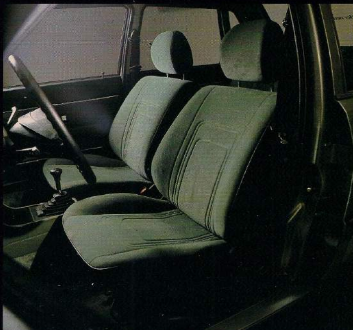
Polster aus Trovipor®-PVC Schaum und aufkaschierten Bezügen — elegante Linienführung durch Hochfrequenzverschweißung
