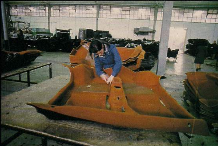
Einbaufertig verformte Textil-Bodengruppe aus der Produktion der Telamin S.p.A.
