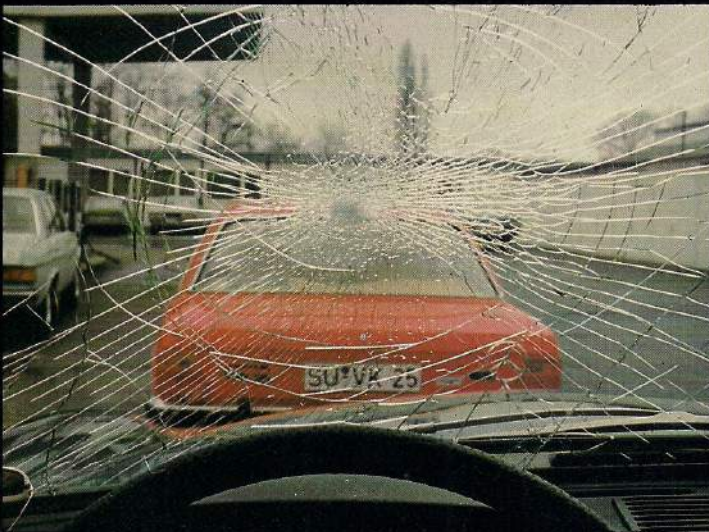
Mit Trosifol®-Folie armiertes Verbund-Sicherheitsglas nach Aufprall
