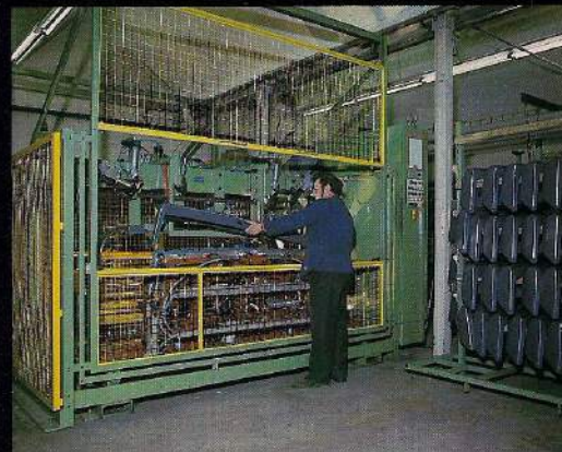
Automatische Aufziehvorrichtung für die Montage extrudierter Zierleisten auf gespritzte Stoßfänger
