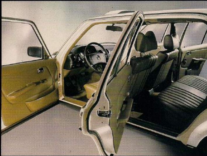
Sitzpolsterungen und Türinnenverkleidungen im Daimler-Benz auf Basis PVC-Schaum Trovipor®
