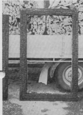
Bild 10. Die Innenseite des Alu-Holz-Fensters nach dem Brandversuch 1 (Anordnung Alu innen).
