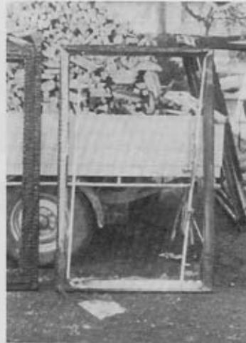
Bild 11. Das Mipolam®-Fenster nach dem Brandversuch 2.
